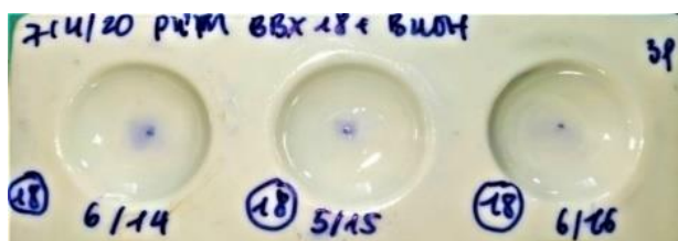
Hình 3.7. BBX18 thành phần mực chứa cả phthalocyanin đồng và phẩm màu triarylmethan - mực viết dễ hòa tan vào dung môi và vẫn để lại màu trên giấy.
