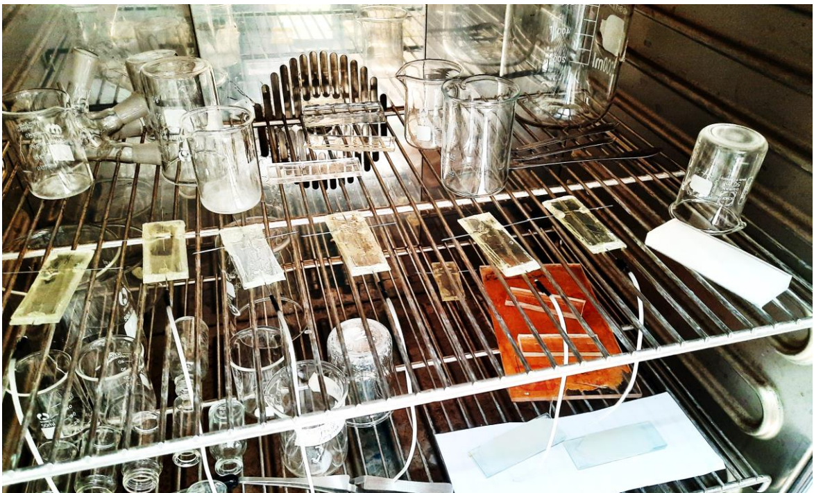
Hình 4.11. 1-4) Các Chip kênh dẫn vi lưu chế tạo được gắn dây nối đầu ra và sấy, bảo quản trong tủ sấy ở nhiệt độ 40 °C.
