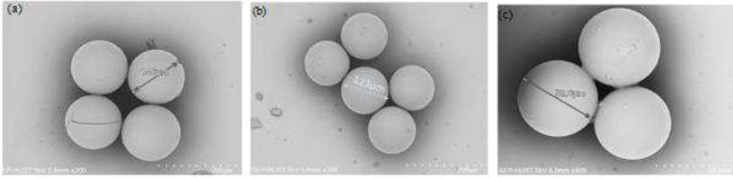
Hình 4.18. a,b) Ảnh SEM của hai cụm vi cầu ở các kích thước khoảng 146 và 123 \mu\text{m} , c) Ảnh SEM của cụm vi cầu ở kích thước khoảng 53 \mu\text{m} .
