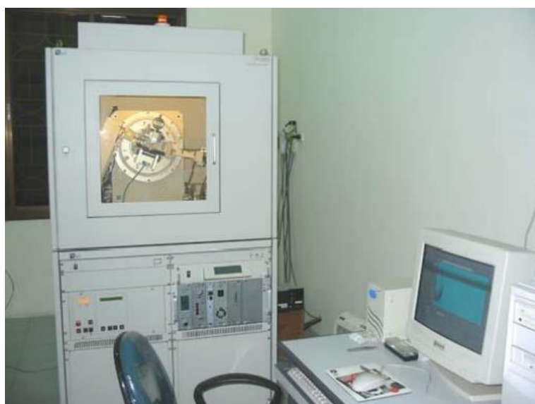
Hình 2.4: Thiết bị máy đo nhiễu xạ tia X SIEMENS D5005, Khoa Vật lý, Trường Đại học Khoa học Tự nhiên.
