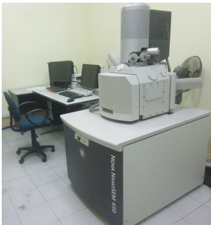
Hình 2.5: Thiết bị kính hiển vi điện tử quét Nova NanoSEM 450, Khoa Vật lý, Trường Đại học Khoa học Tự nhiên.
